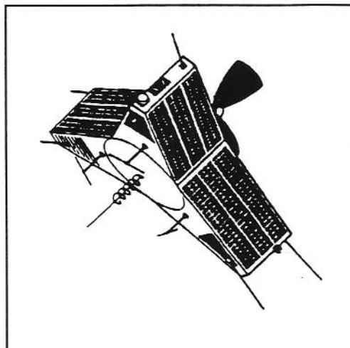
Det var meningen, at den skulle have en inklination på 57° (vinkel med ekvatorialplanet) - men på grund af de skader, der opstod ved bumperiet, kunne den indbyggede motor kun tændes en gang. Det gjorde, at AO-10 endte med en inklination på cirka 26°.
