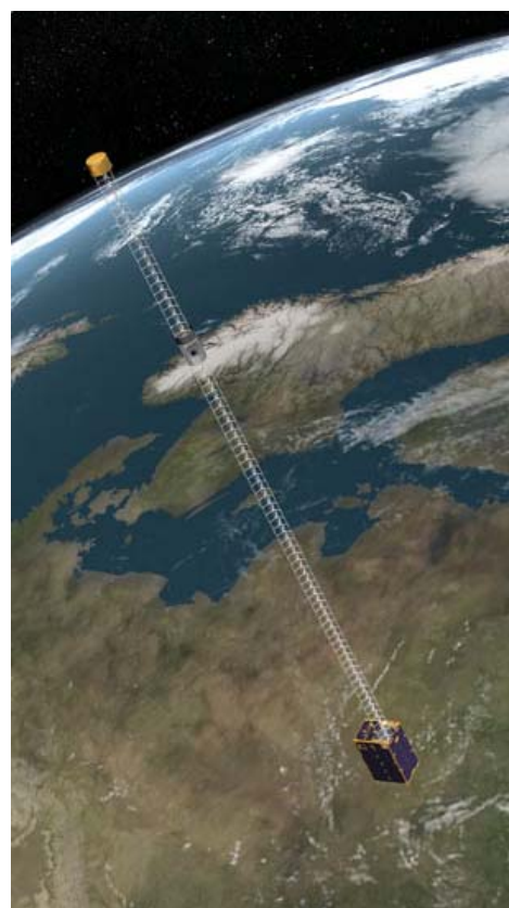
Grafik (vellignende) af Ørstedsatellitten i banen med masten udfoldet. Grafik: Jan Erik Rasmussen, DTU Space.
