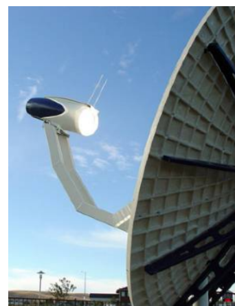
Parabolsolfanger med Stirling motor
